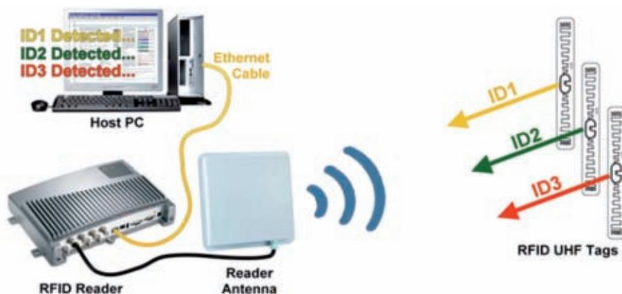
Guardando ai principi di funzionamento della tecnologia RFID, tre sono le entità coinvolte: tag (o transponder); reader o interrogatore; host
